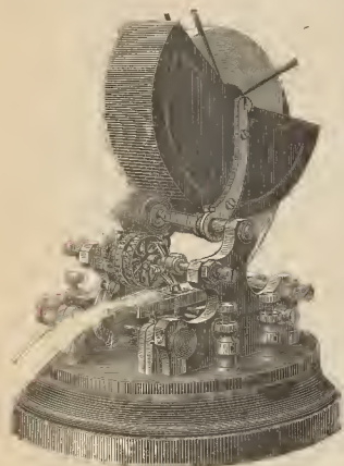
Fig. 1. Aparato receptor de las instalaciones de la Exchange Telegraph Company, de Londres
